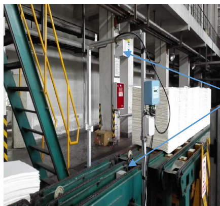
紙・段ボール板の水分測定 (挟み込み式)
